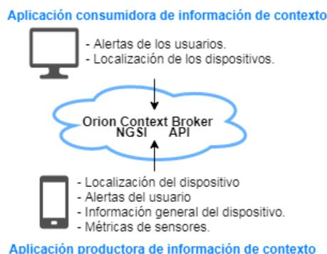
Fig. 1. Esquema del Orion ContextBroker de FIWARE.
